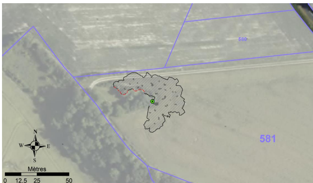
Illustration 5 : Environnement de surface de la carrière souterraine sur orthophoto et cadastre (IGN). Les tirets rouges correspondent aux limites « supposées » de la carrière, au-delà desquelles des extensions actuellement inaccessibles en souterrain sont possibles
